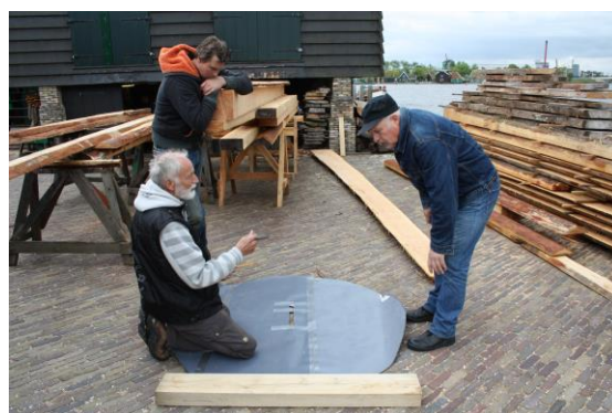
Hout voor de putdeksel uitmeten bij zaagmolen 'Het jonge schaap' in Zaandam.
